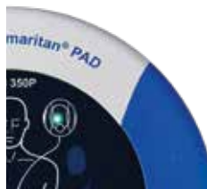
Figur 11. Blinkende grøn LED; ingen handling påkrævet.
